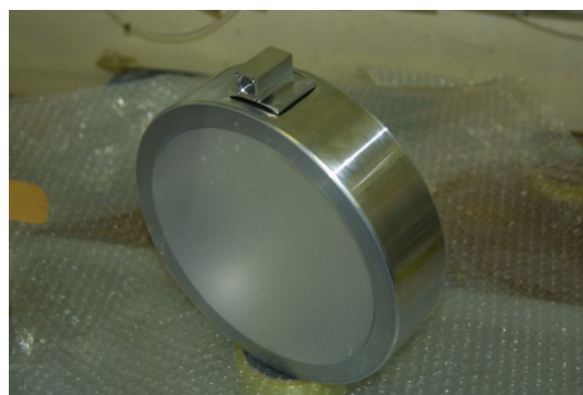
図 5: 実際に製作されたセルの写真。上部にヘリウムを供給するための金具が見える。
